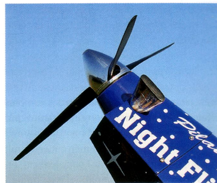
Der Spinner-Rumpf-Übergang am fertigen Modell – auch mit Holz lässt sich die typische Form gut gestalten.
