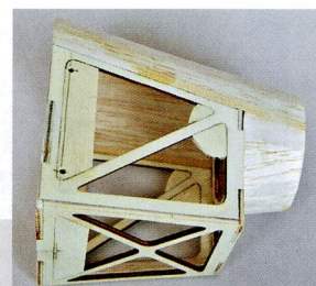
Nix GFK – hier wird auch die Motorhaube aus Holz aufgebaut.
